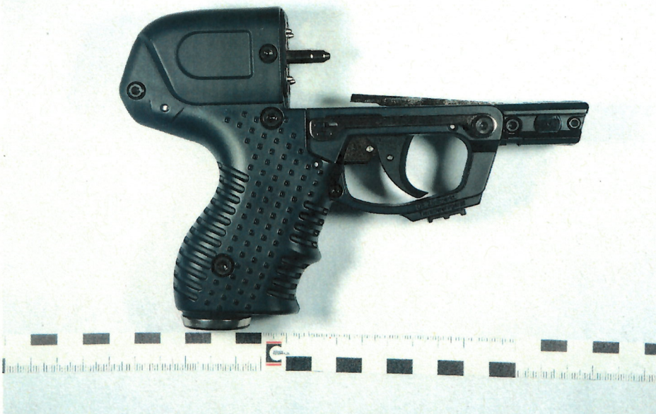
Abbildung 1: Piexon „Jet Protector JPX6“ Ansicht Griffstück ohne Wechselaufsatz
